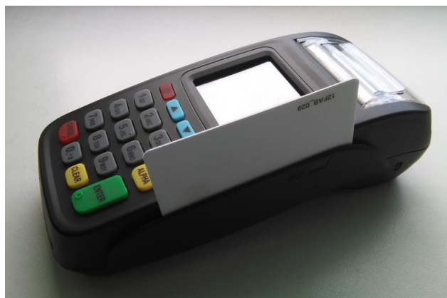
Рис. 4. Считывание карты с магнитной полосой
