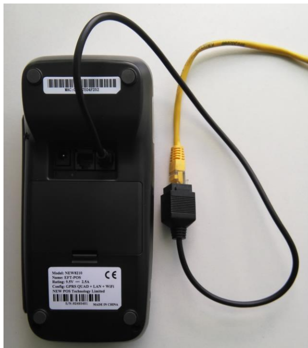
Рис. 9. Подключение к сети Ethernet
